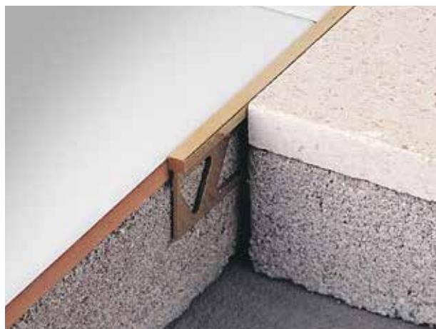
Profil LINETEC MB für eine Verlegung im Dickbettverfahren bei gleichhohen Belägen, wie Terrazzo, Marmor und Parkett mit einer sichtbaren Fläche von 5 oder 10 mm. Der gelochte Schenkel des profils wird in die Mörtelfugenkammer gedrückt und ermöglicht somit eine feste Haftung zwischen den zwei angrenzenden Belägen. Es kann zusammen mit dem Belag abgeschliffen werden und ist in den Ausführungen Messing und Aluminium erhältlich.
